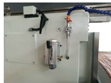
Système de lubrification
