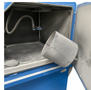
Panier tournant motorisé PT300E Disponible pour toutes les dimensions de cabines.
