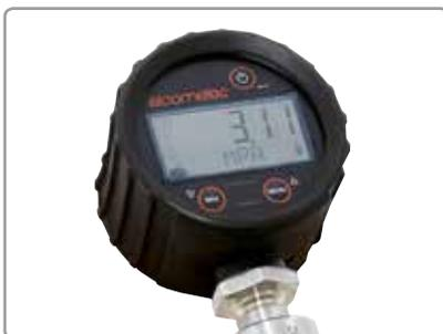
L'écran digital LCD rétroéclairé avec protection en caoutchouc affiche les valeurs en MPa ou psi. La fonction 'Maximum hold' affiche la valeur maximale obtenue.
