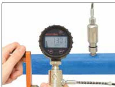
Le câble flexible permet de positionner facilement le raccord sur le plot. La tige est propulsée à travers l'orifice central du plot jusqu'au substrat pour des résultats précis et reproductibles.
