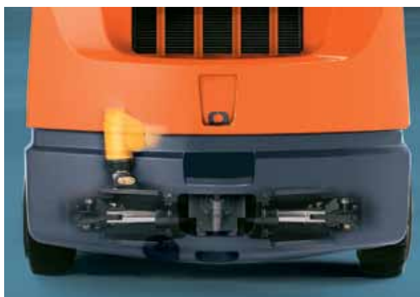
Vérin de blocage de l'oscillation de l'essieu arrière
