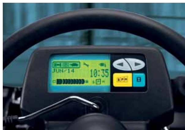
Fonction de sélection de la puissance sur les modèles 7FBCU/7FGCU
