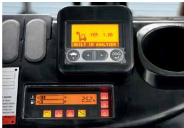
Système d'autodiagnostic embarqué
