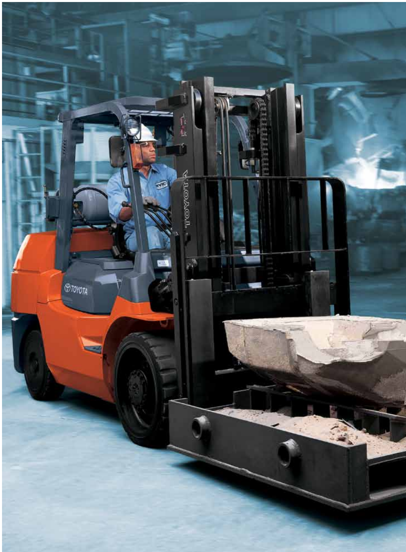
Manutention de charges lourdes : Les chariots à bandage creux équipés de moteurs gaz soulèvent des charges jusqu'à 7,0 t ; les versions électriques manutentionnent des charges jusqu'à 3,0 t.
