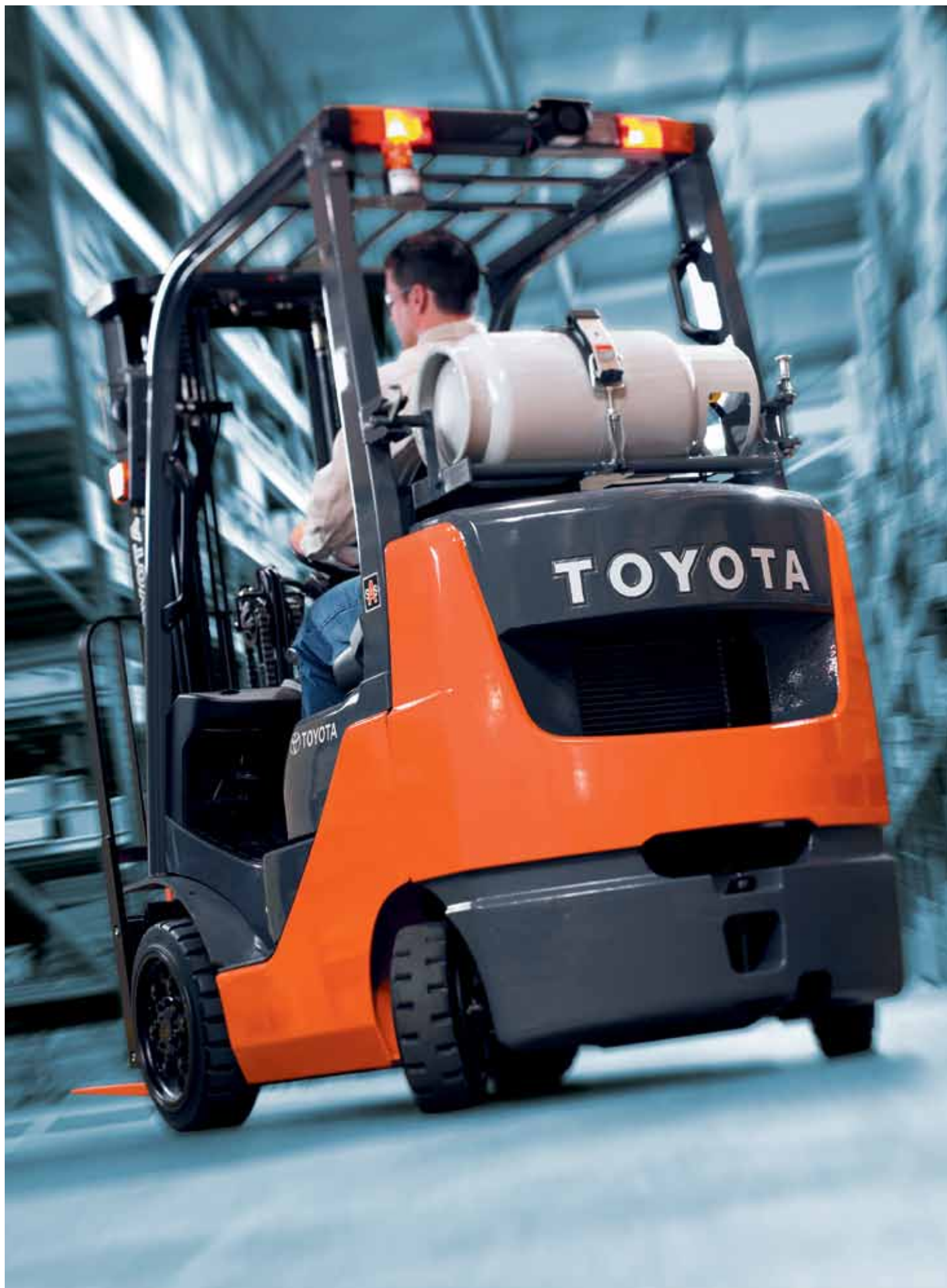
Rayon de braquage court : la technologie à bandage creux facilite la manutention de charges lourdes dans les espaces restreints.
