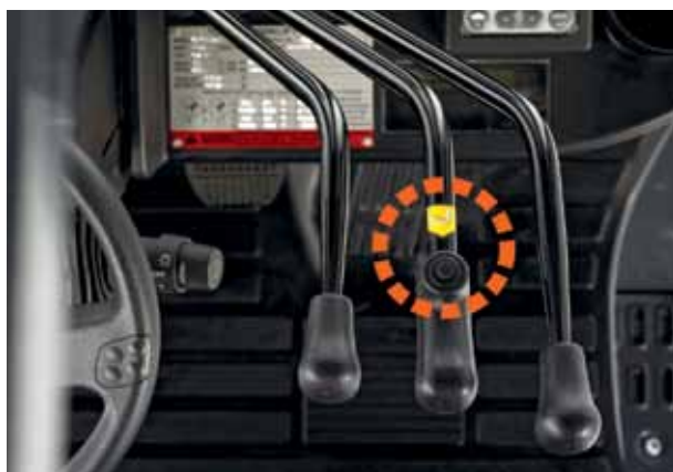
Bouton de nivellement automatique des fourches
