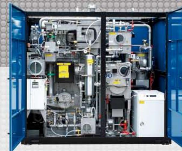
**La série MDMV**, possède les mêmes caractéristiques techniques que la gamme MDM. Elle se différencie par la fonction de séchage sous-vide étudiée particulièrement pour les pièces mécaniques à géométrie complexe et plus spécifiquement pour des pièces ayant des trous borgnes de petits diamètres.
