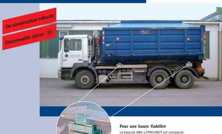
La bascule ARK-3 PFREUNDT est compacte, robuste et ne nécessite aucune maintenance. Haute précision et longévité sont garanties dans de rudes conditions d'utilisation.
