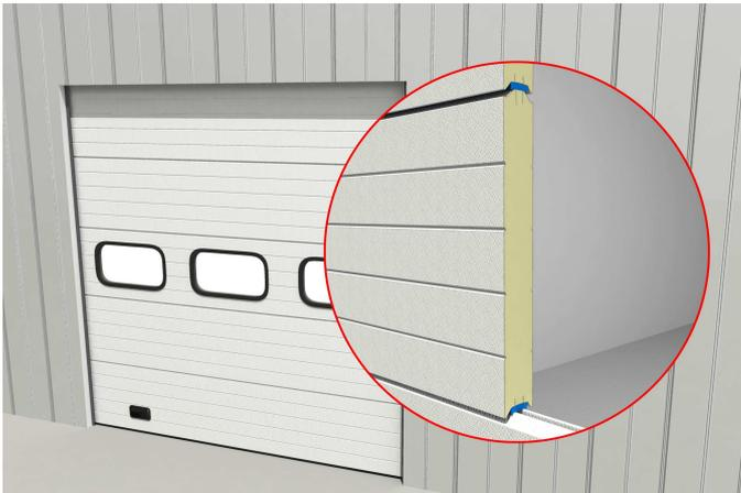
**La porte PowerDoor 601 est une porte sectionale isolante, construite à partir de panneaux sandwich de 40 mm d'épaisseur, composés de deux tôles d'acier, optionnel avec protection anti-pince doigts et d'un noyau en polyuréthane sans CFC.**
