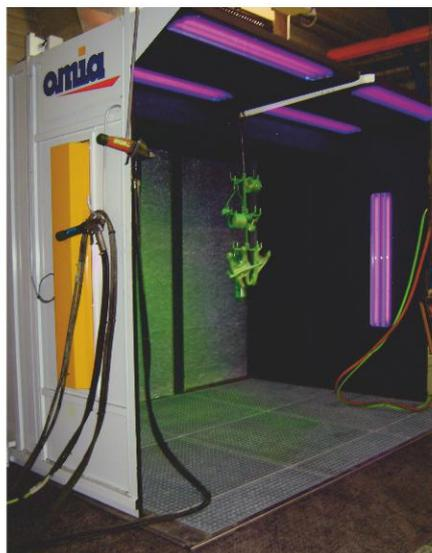
Cabine d'application pénétrant et de rinçage à ventilation horizontale
