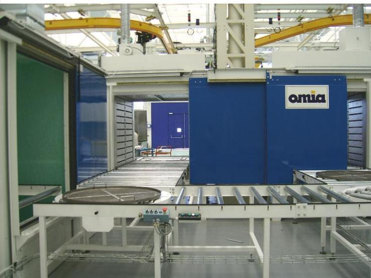
Chaîne de contrôle avec manutention des pièces sur convoyeur à rouleaux
