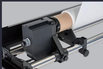
Il empêche l'apparition d'ondulations en bout de ligne sur le support. La reprise stable permet une impression de qualité.
