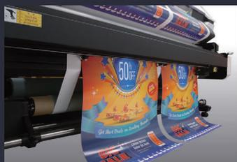
La découpe est possible en ligne à l'horizontale et à la verticale. Le système lit les marques de repérage dédiées et découpe automatiquement les feuilles, ce qui réduit considérablement la main-d'œuvre et optimise l'ensemble du post-traitement.
