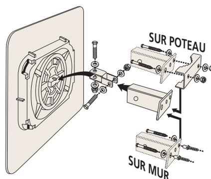
Fixation universelle en acier galvanisé pour murs et poteaux de 60 à 90 mm de section. Permet un réglage très précis de la position du miroir. Testée pour résister au vent jusqu'à 183 km/h.
