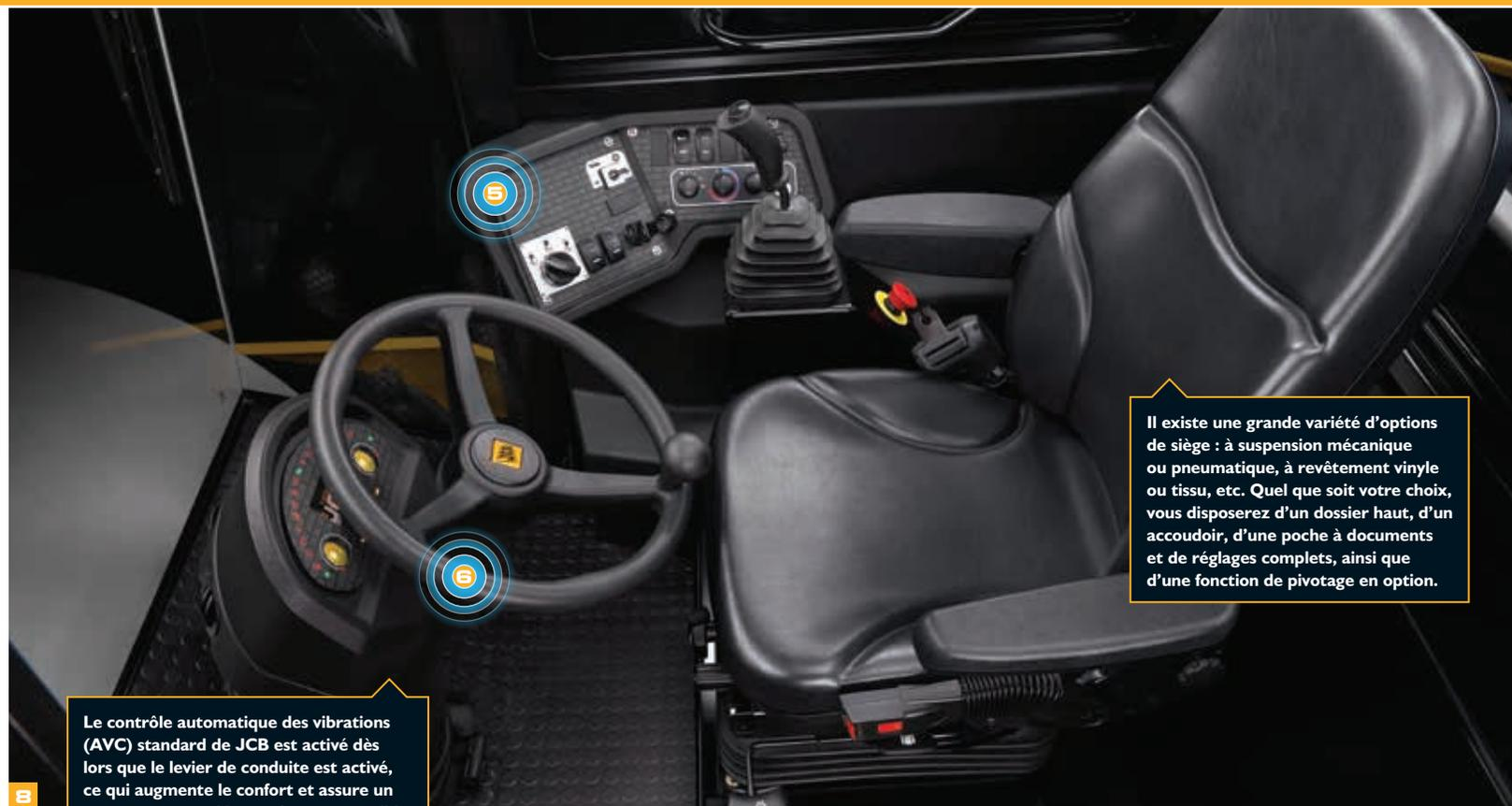
5 Le contrôle automatique des vibrations (AVC) standard de JCB est activé dès lors que le levier de conduite est activé, ce qui augmente le confort et assure un compactage aussi homogène que possible.
