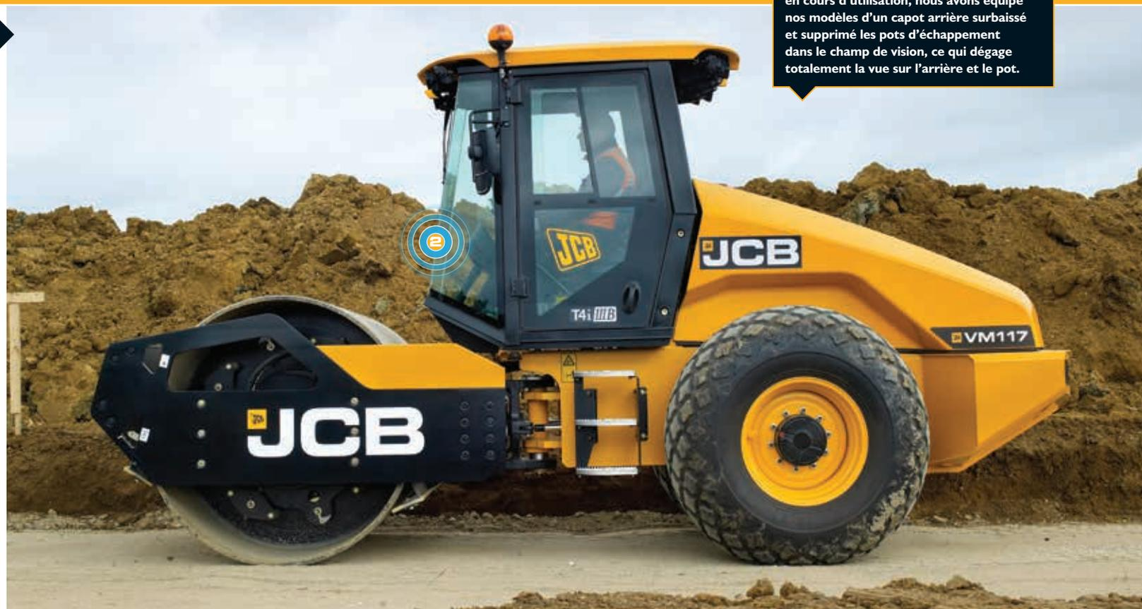
Pour améliorer la sécurité et la précision en cours d'utilisation, nous avons équipé nos modèles d'un capot arrière surbaissé et supprimé les pots d'échappement dans le champ de vision, ce qui dégage totalement la vue sur l'arrière et le pot.
