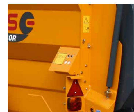
2nd Poste de commande Pilotage de la porte arrière de ramassage pour un gain de temps lors des phases de chargement.
