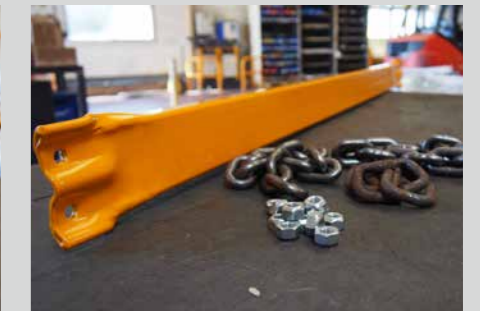
Fond mouvant avec attache rapide en U boulonné pour un entretien facile.
