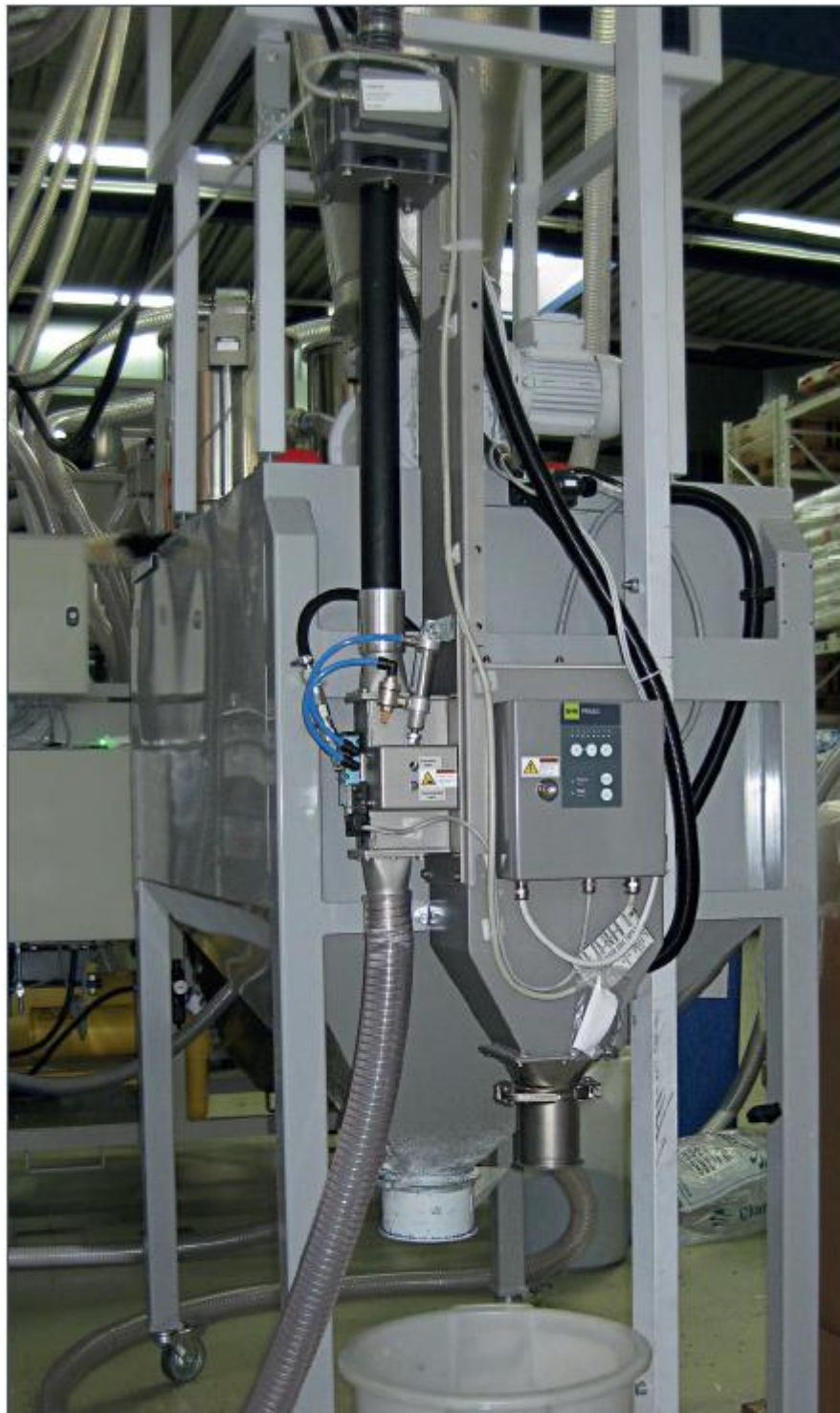
Séparateur de métaux GF intégré dans une conduite pneumatique verticale
