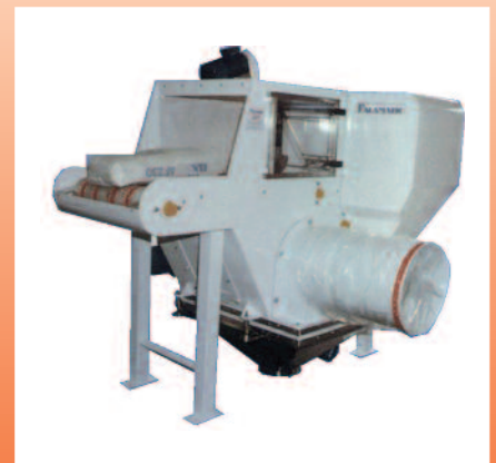
Déssacheuse avec compacteur de sacs intégré
