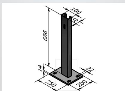
SUPPORT SUR PLATINE À ANCRER MÉCANIQUEMENT OU CHIMIQUEMENT
