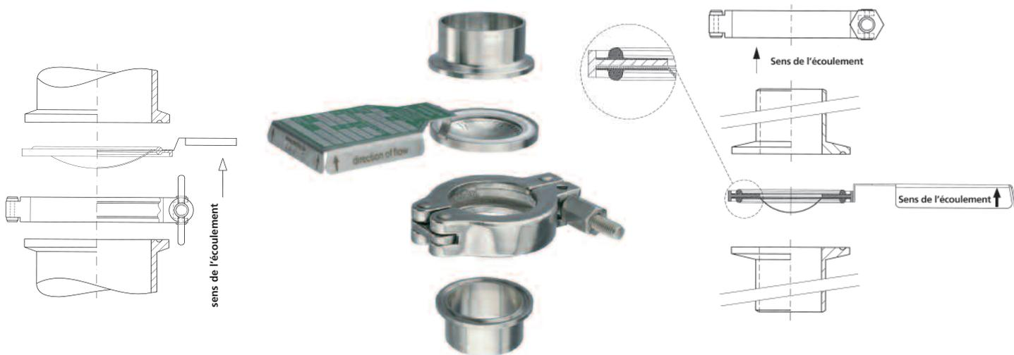
Le TC(R)-KUB® est le résultat d'un travail continu de recherche et développement sur le disque de rupture reverse KUB® à rupture par pattes de flambage. Comme le KUB® est directement intégré dans un joint clamp, un montage direct de ce disque de rupture entre les raccords clamp standards est maintenant possible.
