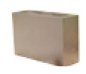
Jardinières réalisées en PSE expansé d'une densité de 20 à 40kg/m³, recouvert de polyurée aromatique à chaud (70°) Finition peinture polyuréthane bi-composant (RAL au choix)
