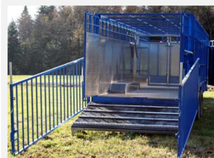
Fond ouvrant intégral avec accrochage automatique des portes
