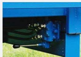
Distributeur hydraulique commande arrière
