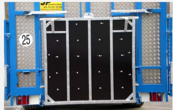
Pont repliable 2 positions avec fermeture automatique
