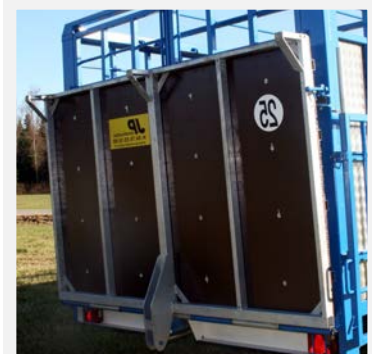
Pont hydraulique avec distributeur sur l'arrière
