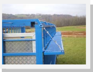
Plancher caoutchouc sur l'aluminium: évite la résonance
