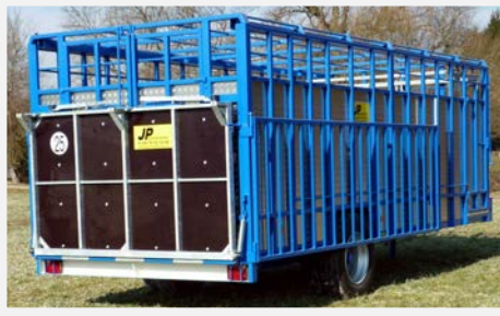
Pont à ressorts + accrochage automatique
