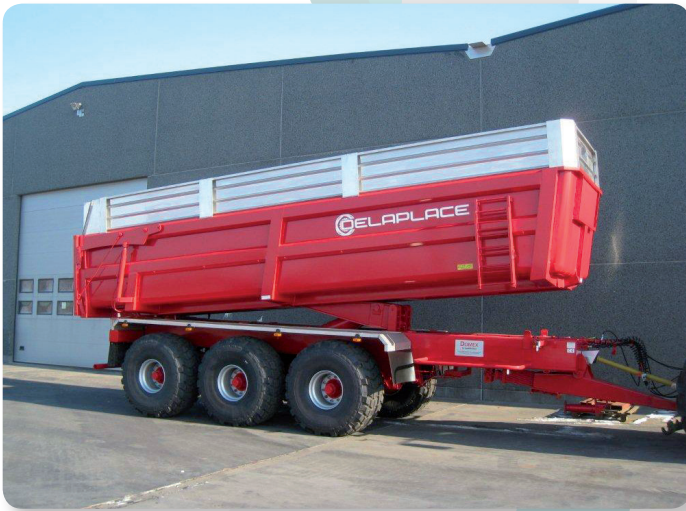
Remorque 24 Tonnes homologuée 40 km/h avec freinage pneumatique 40 km/h approved 24 ton trailer with air brake system
