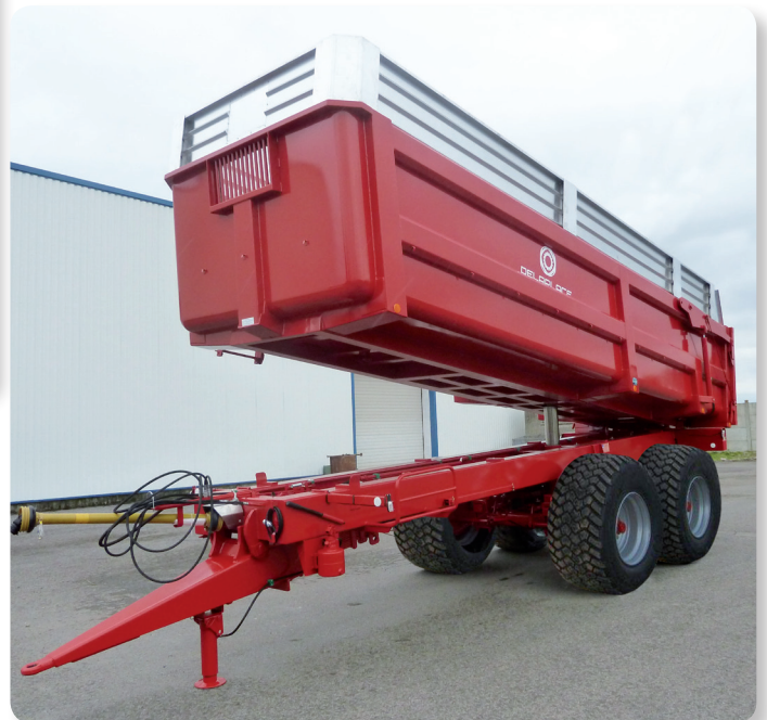
Remorque 24 Tonnes homologuée 40 km/h avec freinage pneumatique 40 km/h approved 24 ton trailer with air brake system
