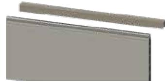
**ÉTAPE 10** Insérer un U de finition dans le poteau pour compenser l'épaisseur du panneau (24mm). Glisser les panneaux d'un seul tenant à l'intérieur des poteaux en laissant un jeu de 5mm de chaque côté
