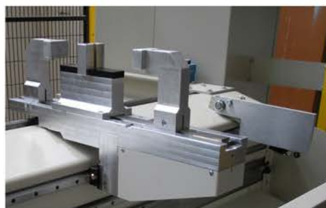
Etaux doubles permettant de maintenir deux profilés simultanément
