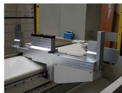
Etaux avec support intermédiaire pour usiner des panneaux jusqu'à 650 mm
