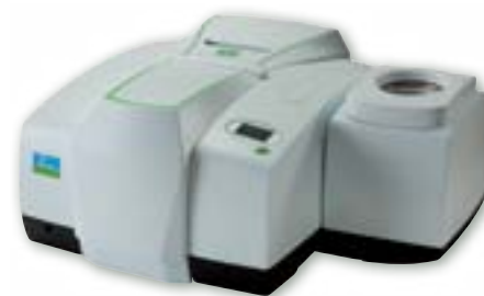
Système Frontier IR/NIR avec réflexion NIR et porte-échantillon rotatif : quantification dans les produits agroalimentaires
