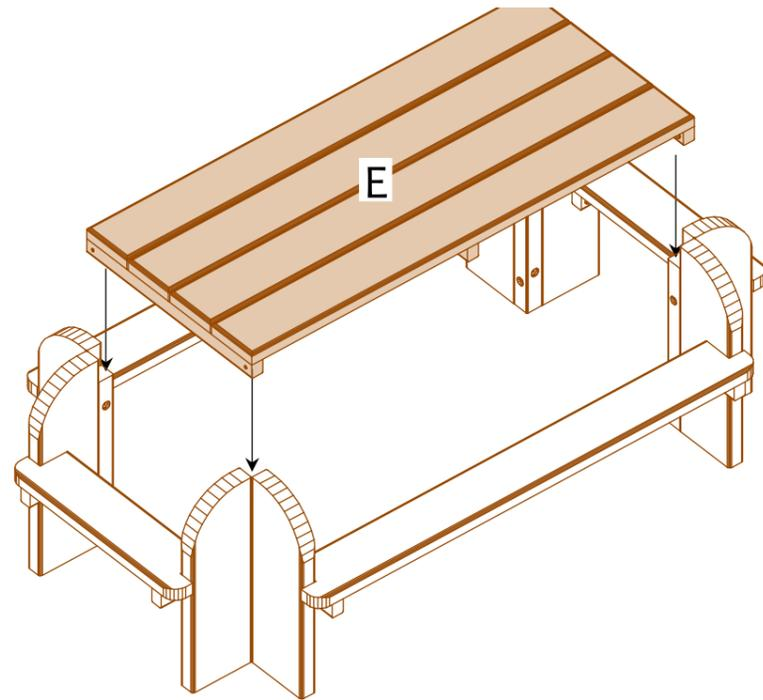
Positionner le plateau sur les 4 pieds et fixer celui-ci dans chaque angle à l'aide de tirefonds de 10x100 (T1). Fixer au sol la table à l'aide de pattes à scellement et tirefonds (T3) 6x45 + rondelles.
