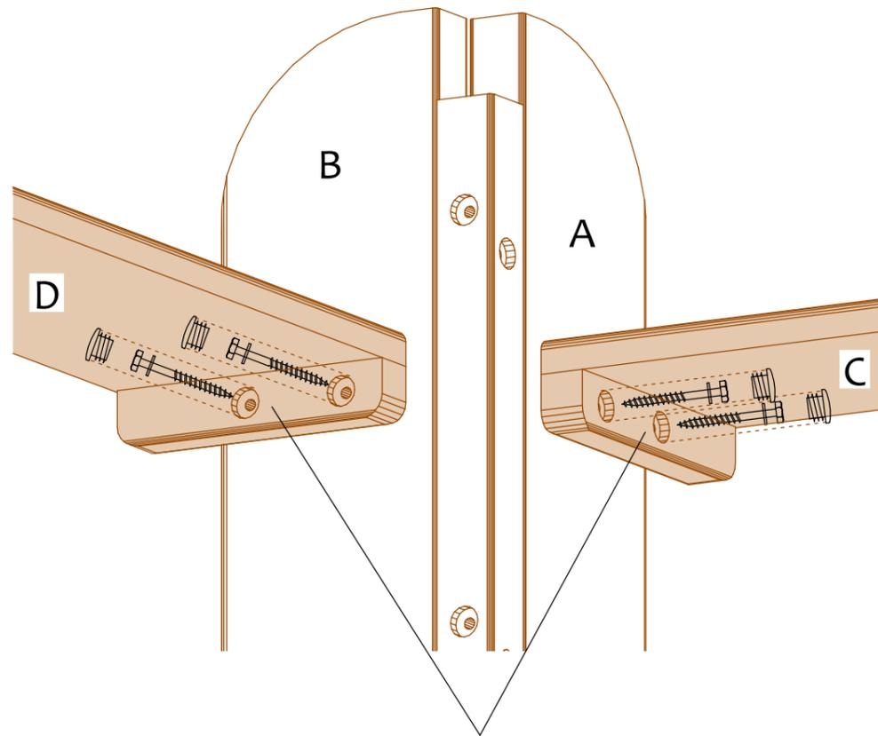
principe fixation éléments C
