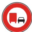
B3a Interdiction aux transports de plus de 3,5 t. de dépasser tous les véhicules moteur autres que les 2 roues sans side-car
