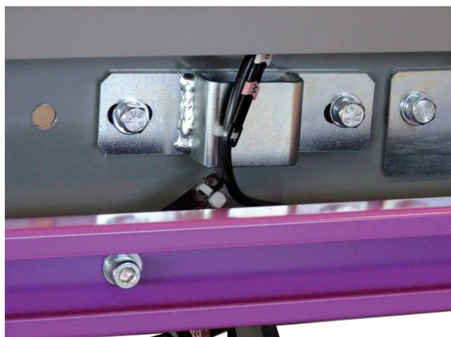
Vue de pièces servant à la reprise de couple du rouleau moteur ainsi qu'à la protection de son câble électrique de commande
