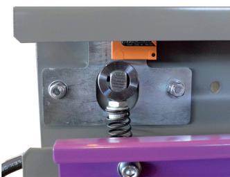
Vue du système palpeur intégré dans le longeron du convoyeur avec son capteur inductif
