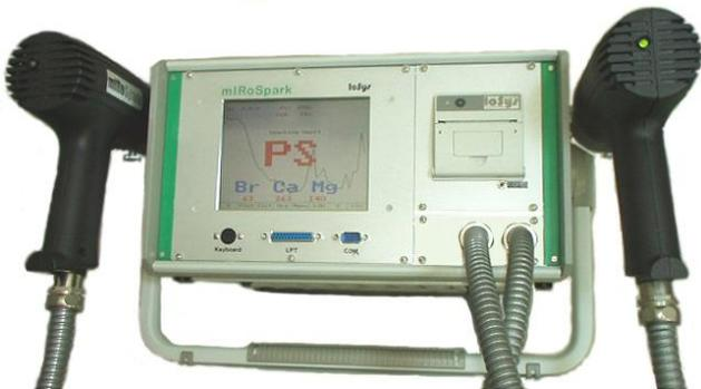
Le principe de cette technologie est la spectrométrie proche infrarouge. Elle permet d'établir des modèles caractéristiques d'absorption. Suite à l'évaporation, via brulure à haute température d'une partie infime de l'échantillon, on obtient la reconnaissance du plastique grâce à une base de données intégrée complète.
