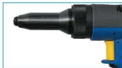
La soupape commandée par la gâchette jaune de l'outil est connectée en série avec une seconde soupape commandée par la tête. Ainsi, le déclenchement n'est possible que si la pression exercée par l'opérateur est supérieure à la pression des ressorts installés dans la tête. Ces ressorts peuvent constituer des seuils de 40N, 55N, 70N et 85N, suivant le nombre installé. Aucun réglage n'est nécessaire et une dérive du seuil de pression est impossible.
