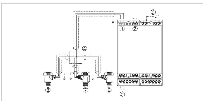
Exemple de raccordement VEGASCAN 693 avec capteurs bifilaires
