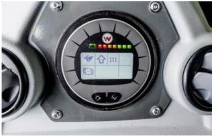
Le niveau de charge est affiché au tableau de bord sous forme de diodes lumineuses (rouge-orange-verte).
