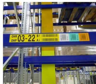
L'étiquette est posée sur la première lisse, le premier niveau étant au sol. La partie jaune indique les emplacements en- et au-dessus de la première lisse. Les niveaux supérieurs sont indiqués par des couleurs différentes.
