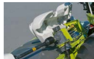
Embrayage hydraulique pour l'activation séquentielle de la vis et du lamier
