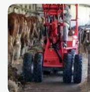
7. DISPOSITIF DE JUMELAGE SUR PONT AVANT
