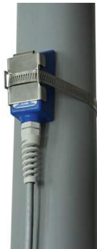
Sonde du Pulsar DFS-5.1 bridée par collier sur la conduite
