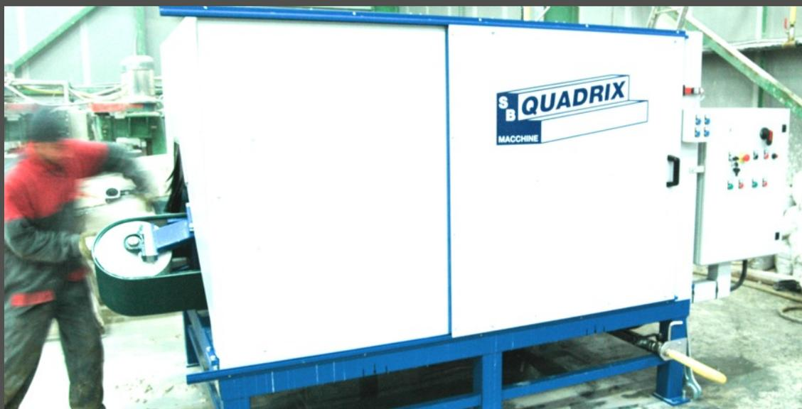
Machine conçue pour la réalisation de chaîne d'angle en pierre de 10mm à 100mm d'épaisseur à partir de billettes.
