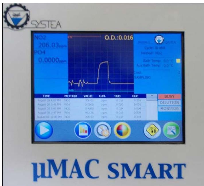
**$\mu$ MAC SMART** est un analyseur portable piloté par un PC intégré et contrôlé via l'écran tactile couleur, il est spécialement conçu pour la surveillance sur site des ressources en eau.
