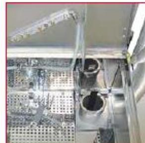
Lors de l'utilisation, le capot supérieur de l'enceinte est relevé et permet de déclencher le système d'aspiration des vapeurs liées au nettoyage. Les conduites seront reliées au système d'aspiration de l'entreprise (hors fourniture).
