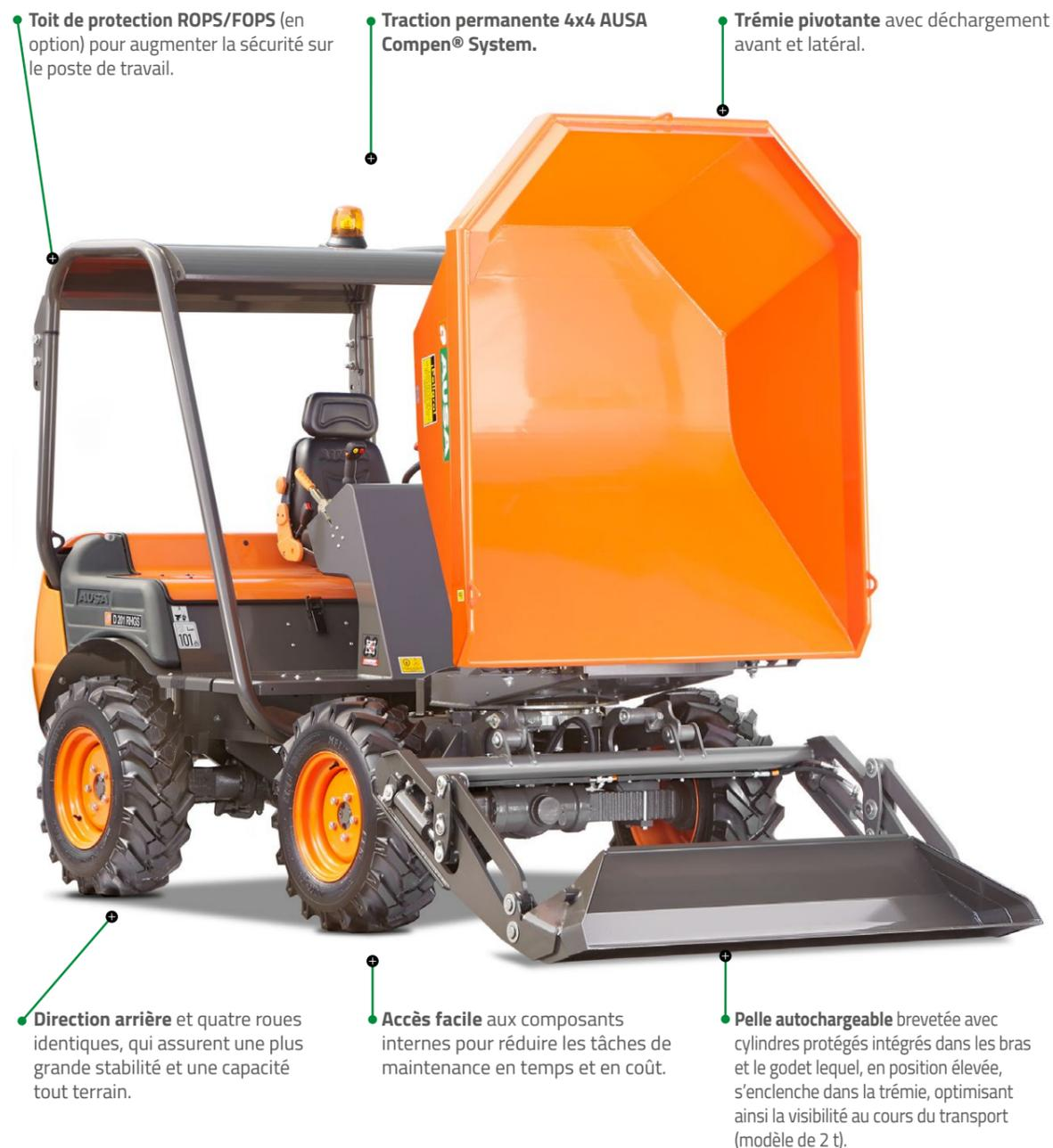
**ÉQUIPEMENT DE SÉRIE:** Gyrophare (D 201 RHS/RHGS), avertisseur sonore de recul, siège réglable, ceinture de sécurité enroulable, protection contre le vandalisme, pelle autochargeable et direction assistée, arceau de protection rabattable ROPS (D 201 RHS/RHGS).
