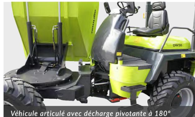
Véhicule articulé avec décharge pivotante à 180°
