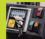
**Couvercle de serrure d'allumage.** Scelle le contacteur d'allumage lorsque la clé est sortie pour le protéger de la corrosion et de la saleté.
