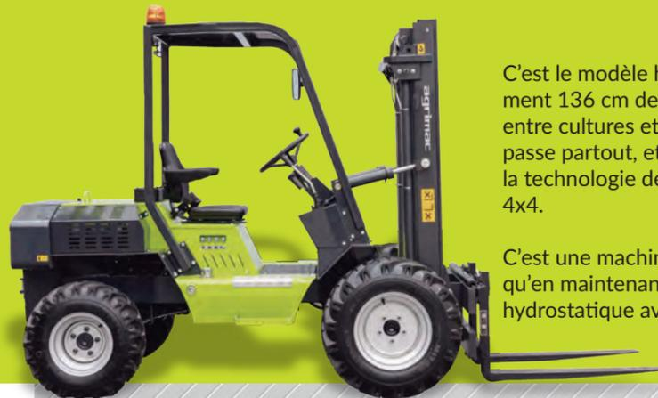
C'est le modèle hydrostatique le plus compact d'Agrimac. Seulement 136 cm de largeur. Une dimension idéale pour la manipulation entre cultures et constructions avec peu d'espace. Il est petit et passe partout, et en même temps puissant et agile. Il est équipé de la technologie de moteur intra-roue dans ses deux versions : 4x2 et 4x4.
