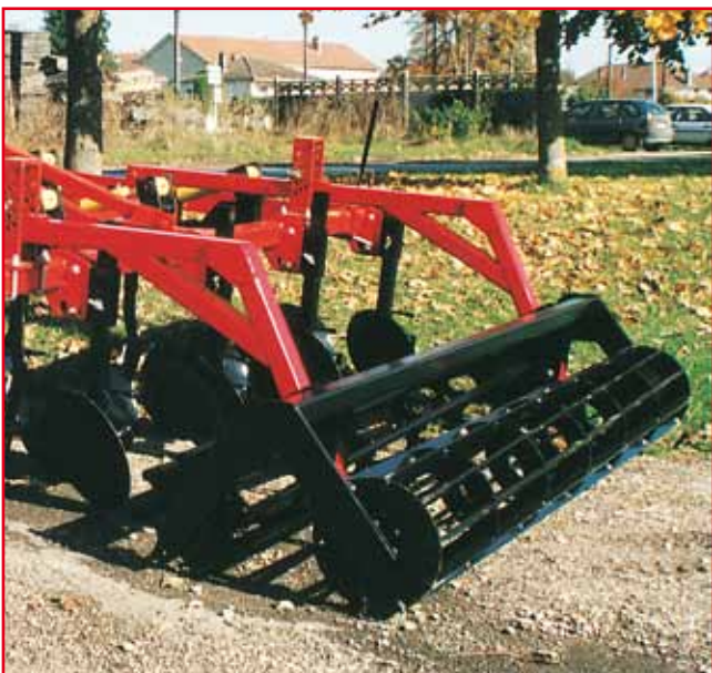
Double rouleau arrière Ø 400. Rear double roll Ø 400. - Hintere doppelte Walze Ø 400.
