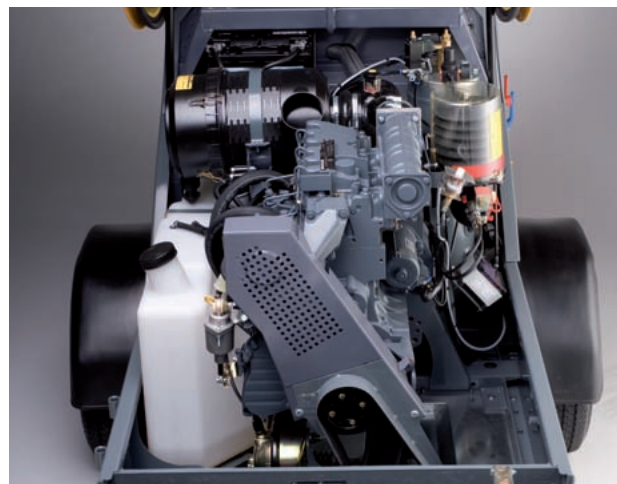
Le moteur diesel est installé en ligne. L'ensemble est ainsi bien rangé et accessible.
