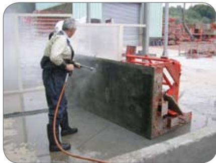
Décapage de banches métalliques
