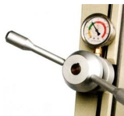
réglage de tension du ruban
