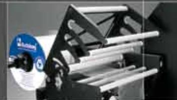
La conception des courroies d'alimentation serre le rouleau de sacs et permet de maintenir une position constante pour un chargement du produit et un soudage précis.
