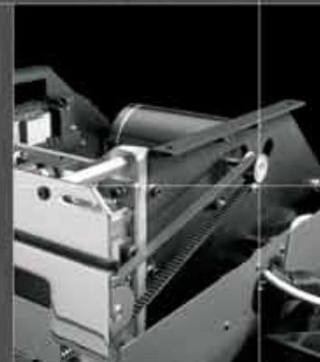
Le dévidoir motorisé, une exclusivité des systèmes Autobag, permet un alignement du film et un contrôle de la tension pour une livraison cohérente du film vers la zone de chargement du produit.
