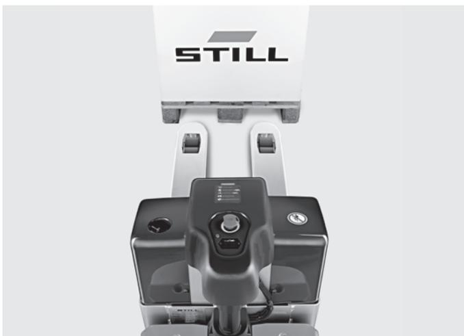
Profil surbaissé : meilleure tenue au sol et visibilité optimale sur les pointes de fourches<sup>3</sup>
