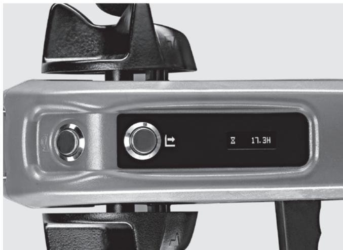
Toutes les informations nécessaires d'un coup d'oeil : afficheur multifonction avec horamètre, état de la batterie et instructions d'utilisation<sup>2</sup>
