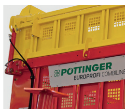
Repliage hydraulique du volet frontal
