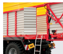
Porte d'accès latérale avec échelle
