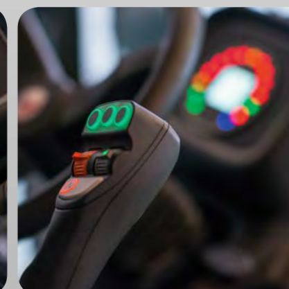
Pilotage réactif et précis de la machine et des équipements à moyen d'un joystick à commande pilote hydraulique.
