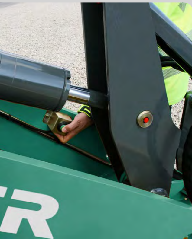
Décompression du 3 e circuit hydraulique – pour un accouplement/désaccouplement simple des équipements pourvus de fonctions hydrauliques auxiliaires.
