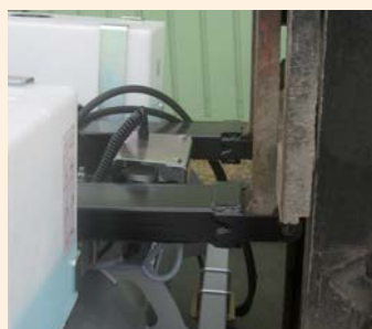
Kit d'accrochage sur fourreaux flottants avec fixations sécurisées
