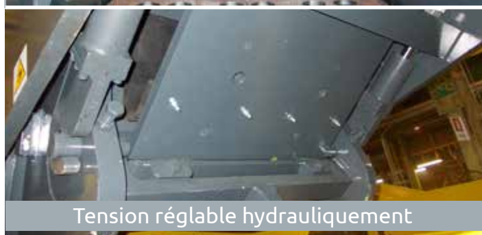
Réglage hydraulique de l'écartement pour éviter toute obstruction
