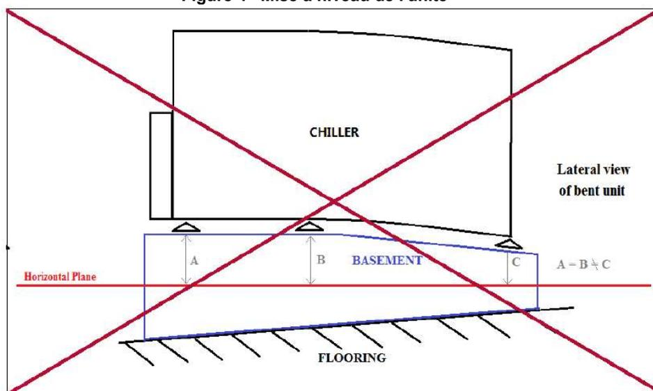
Pour l'installation au sol, il convient de prévoir une forte base solide, d'une épaisseur minimum de 250 mm et d'une largeur supérieure à celle de l'unité. Cette base doit être en mesure de supporter le poids de l'unité.
