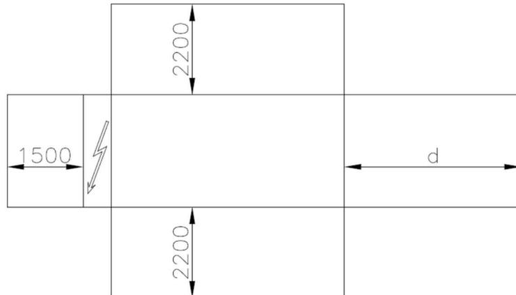
$d = 1500$  mm pour les unités à circuit unique ;  $d = 3000/3500$  mm (selon la dimension de l'évaporateur) pour les unités à double circuit
