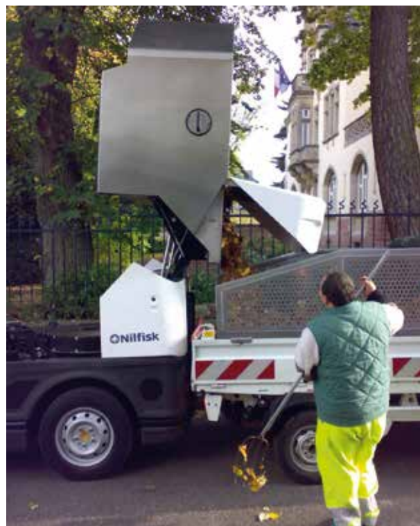
Bennage hydraulique, directement dans les conteneurs industriels
